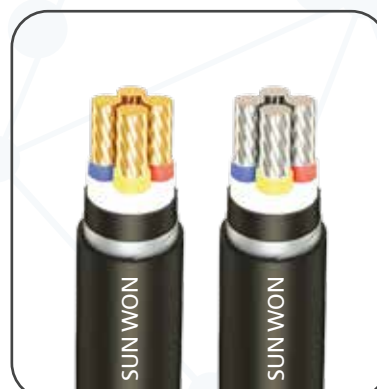
Cáp đồng, nhôm ngầm AL (CU) / XLPE / PVC / DSTA / PVC
