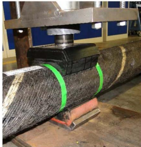
Hình 2: Kiểm tra độ bền với miếng đệm theo dõi sâu bướm ban đầu
