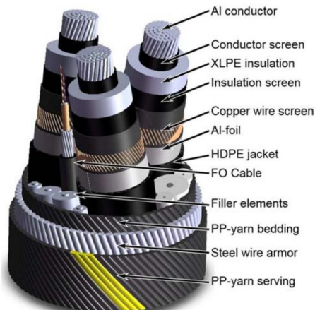
Hình 1: Bản vẽ sơ đồ thiết kế cáp điện ngầm.
