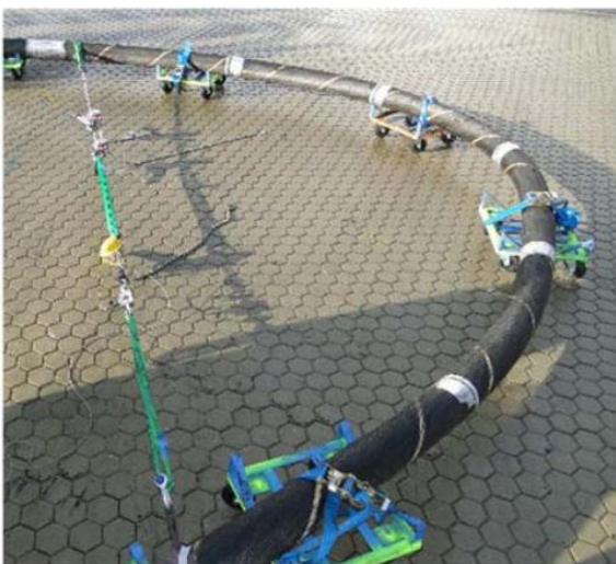
Hình 4: Bố trí thử nghiệm để đo mômen uốn và độ cong để khảo sát độ cứng uốn.
