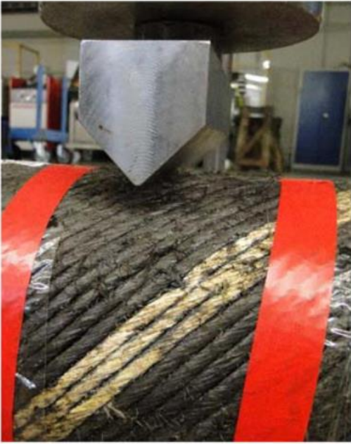
Hình 3: Thử nghiệm Va đập, búa va đập có bán kính cong là 2 mm.
