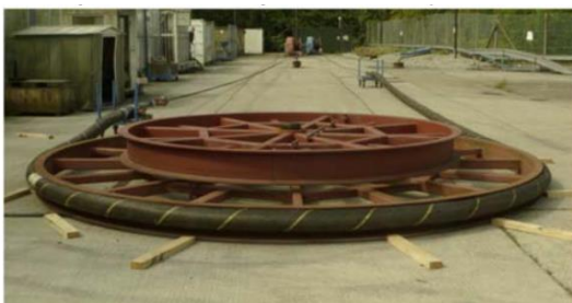
Hình 7: Thử nghiệm độ uốn khi kéo của cáp điện ngầm XLPE 3x 800 mm 2 19/33 (36) kV xung quanh một pully 5,4 m.
